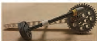
上圖是用來將轉動轉換成往復運動的簡單LEGO模型。類似這種機構常用在蒸汽機、發電機、引擎活塞。(如右圖)
